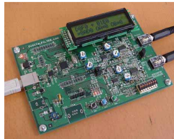
D-Aコンバータ内蔵の高性能なdsPIC33FJ128GP804を搭載した基板！
