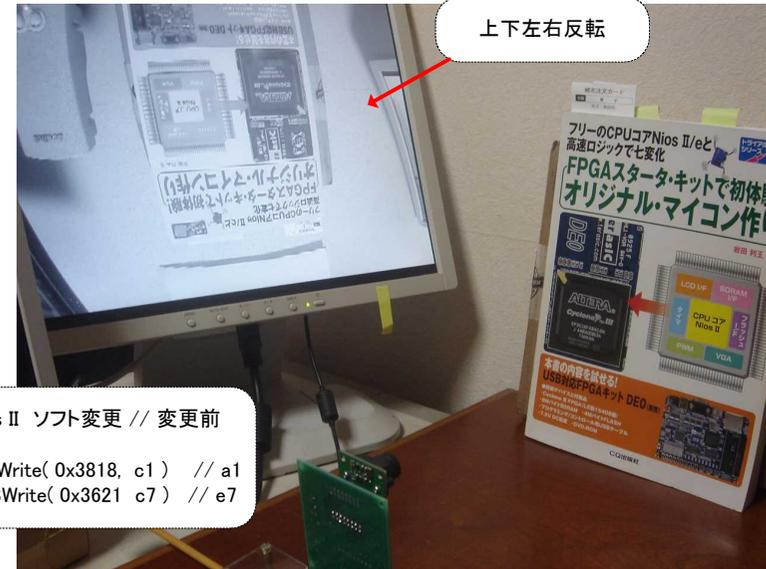
写真1-11 カメラのレジスタを少し変えてみる
