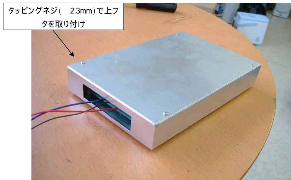
タッピングネジ( 2.3mm)で上フタを取り付け(top view)
